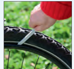
Reifen-Montierhebel in Anwendung
