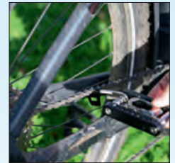
Kettenbrecher in Anwendung
